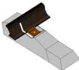
Рисунок 3.33 "Маячная" шпала для контроля угона пути для бесподкладочных креплений ЖБР-65, ЖБР-65Ш, СМ-1, W-30
