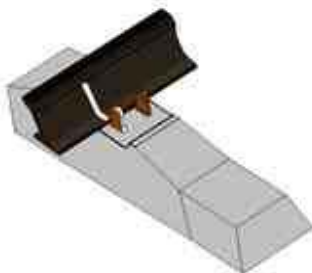
Рисунок 3.34 "Маячная" шпала для контроля угона пути для анкерных креплений
