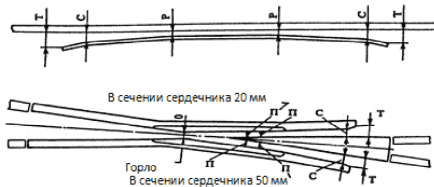
Рисунок 3.12. Места контрольных измерений ширины желобов в острых
