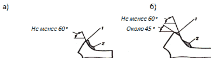
Рисунок 3.26. Профиль зачистки выкрошенного остряка: а) до первой тяги; б) за первой тягой на участке до сечения остряка 20 мм; 1 - выкрашивание головки; 2 - горизонтальный уступ.
