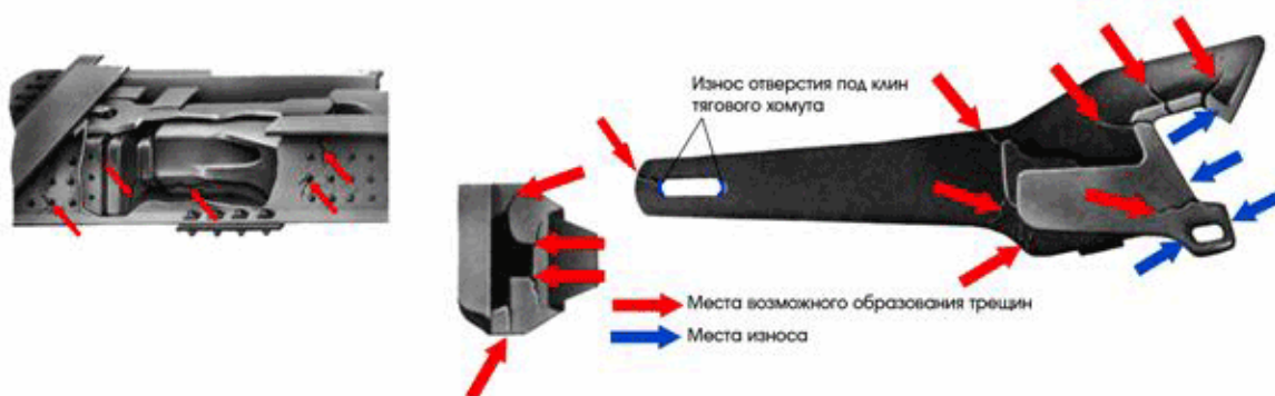
Рис. 3.16. Неисправности автосцепного устройства
