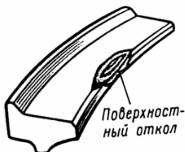
Рис. 3.3. Поверхностный откол наружной грани обода колеса
