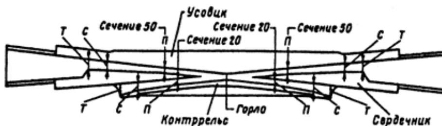
Рисунок 3.14. Места контрольных измерений ширины желобов в тупых крестовинах (мм) (измерения проводятся в местах видимых переломов контррельсах и нерабочей грани сердечника)
